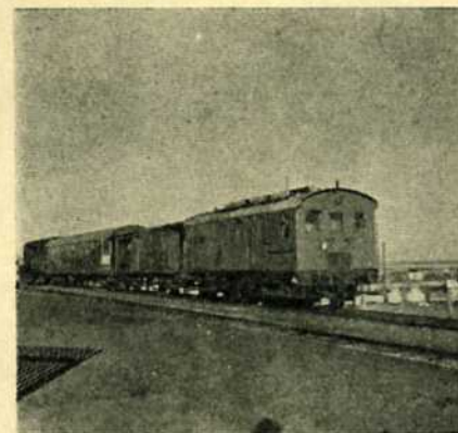
Gennemsnitstoget af 1959. Personvognen er en 4-akslet truckvogn bygget af Scandia efter krigen (89 siddepl.)
